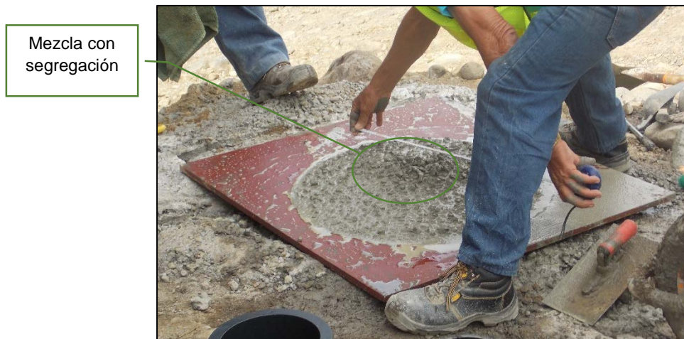
Figura 17. Medición del flujo de asentamiento en el puente río Toro Amarillo, km 50+975. Fecha de la fotografía 24-01-2019. Fuente: LanammeUCR
