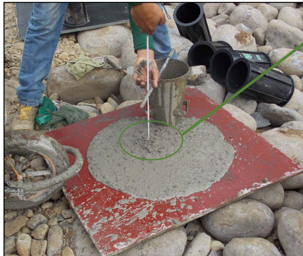
Figura 16. Medición del asentamiento en concreto autocompactante, puente río Corinto, km 50+975. Fecha de la fotografía 24-01-2019.
