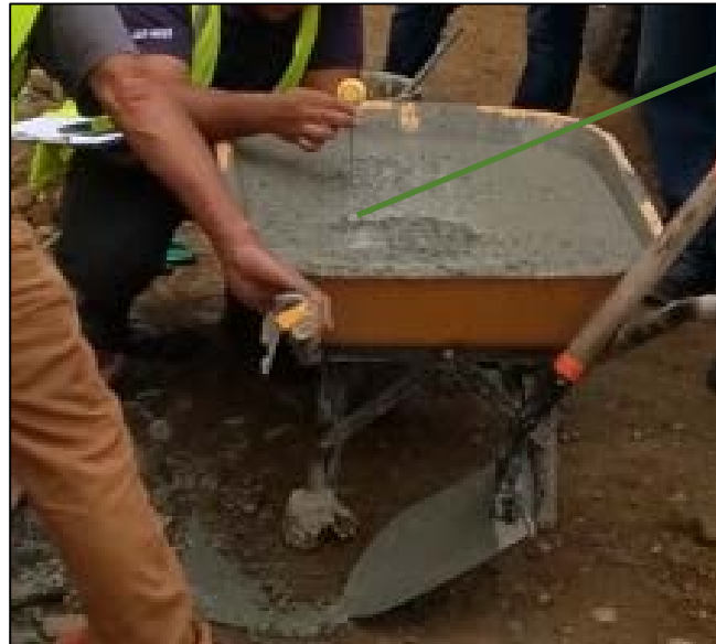
Figura 18. Medición de la temperatura del concreto fresco en el río Toro, km 59+124.
