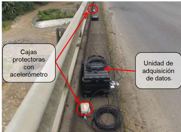
**Figura 32.** Colocación de sensores sobre las aceras del puente. Nótese que el monitoreo no interrumpe el tránsito de vehículos.
