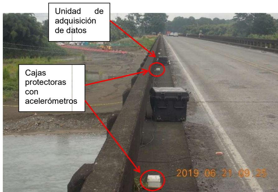
**Figura 5.** Ejemplo de toma de datos sobre las aceras de un puente, nótese que no es necesaria la interrupción del tránsito vehicular
