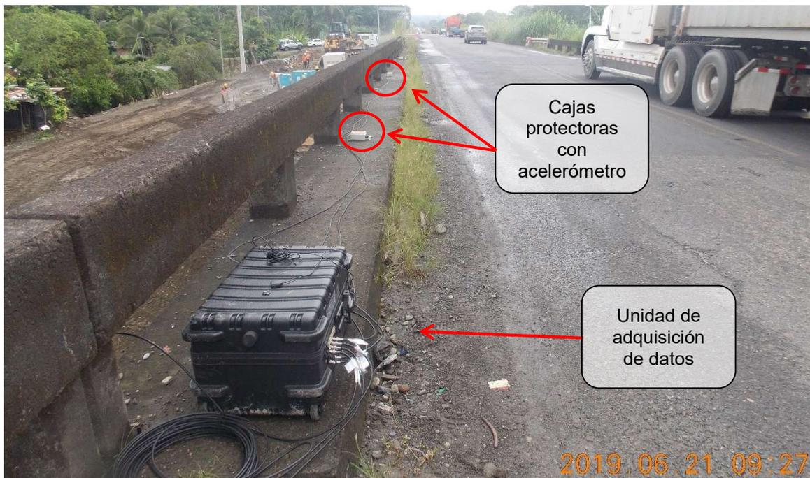
**Figura 13.** Colocación de sensores sobre las aceras del puente. Nótese que el monitoreo no interrumpe el tránsito de vehículos
