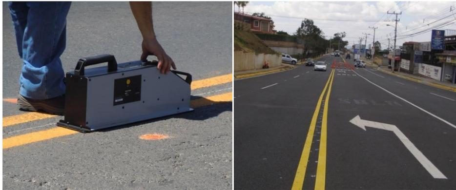
Figura 9. 16. Medición de retroreflectividad en demarcación vial horizontal
