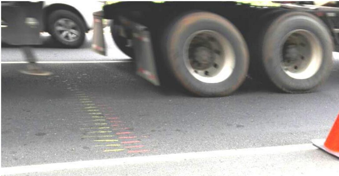
Figura 7. 2. Marcas en el pavimento utilizadas para validar el método de sensores ultrasónicos
