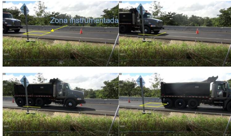
Figura 9. 13. Paso de la vagoneta sobre zona instrumentada
