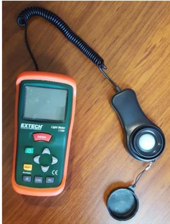
Figura 11. 5. Equipo para la medición de la iluminancia
