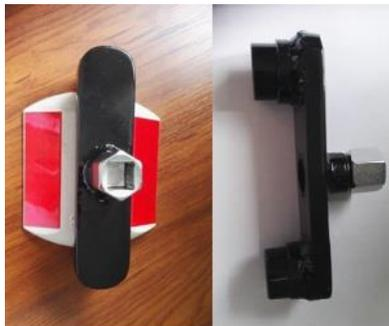
Figura 2. 8. Herramienta utilizada para la transición entre el torquímetro y el captaluz
