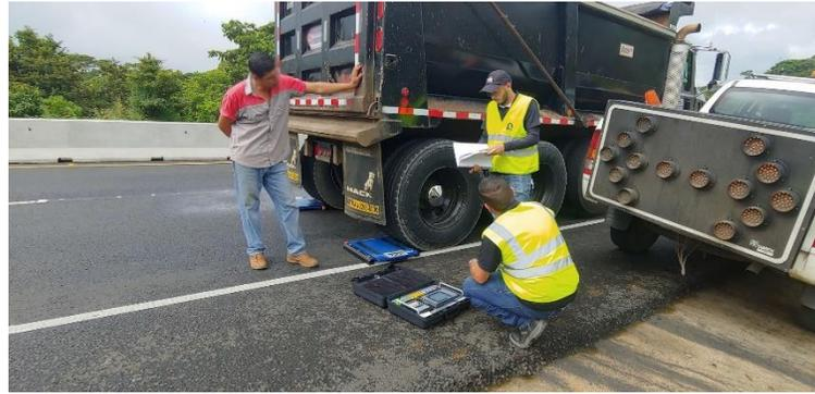
Figura 9. 12. Pesaje de vagoneta antes de la prueba de carga
