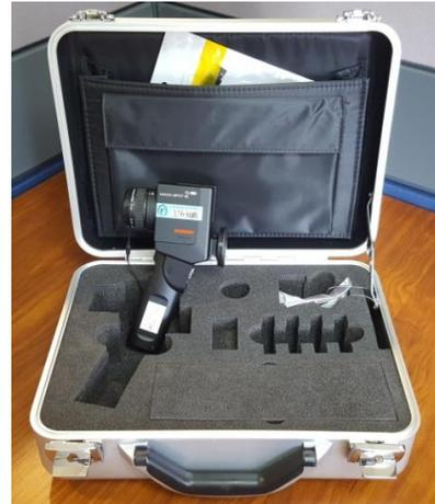
Figura 11. 6. Equipo para la medición de la luminancia
