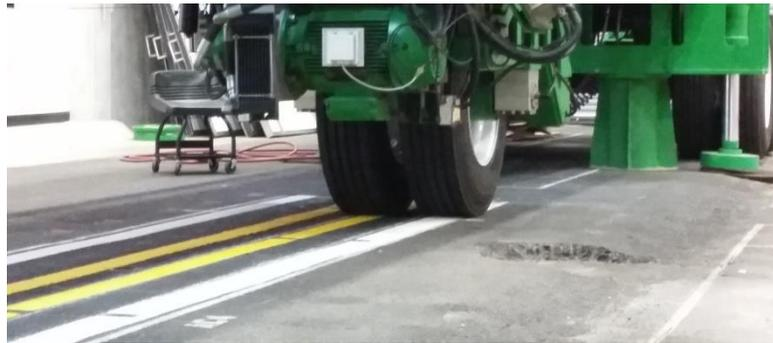
Figura 9. 17. Líneas de ensayo bajo el efecto del simulador de vehículo pesado (HVS)
