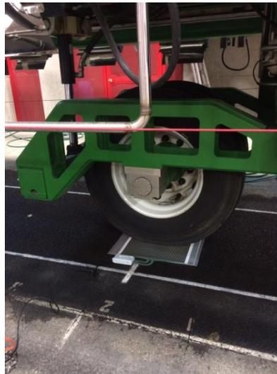
Figura 10. 13. Mediciones realizadas con sensores de presión planos y el HVS
