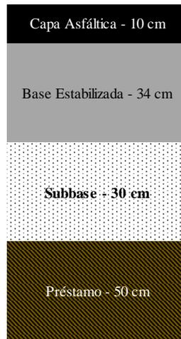
Figura 9 Paquete estructural Paso Ancho, según el contrato
