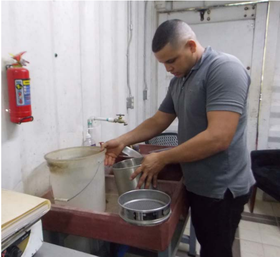
Fotografía 9. Técnico del laboratorio de OJM decantando el agua en el ensayo de máxima teórica en el laboratorio de OJM en la planta de Mecó en San Carlos. Fecha: 22 de agosto de 2019. Fuente: LanammeUCR
