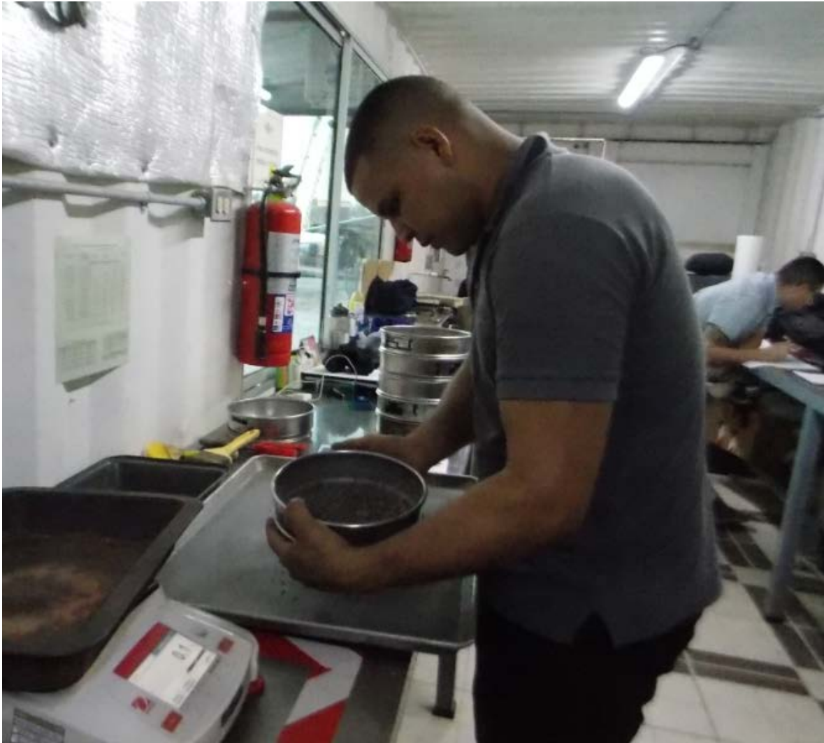
Fotografía 10. Técnico del laboratorio de OJM realizando ensayo de granulometría en el laboratorio de OJM en la planta de Meco en San Carlos. Fecha: 22 de agosto de 2019. Fuente: LanammeUCR
