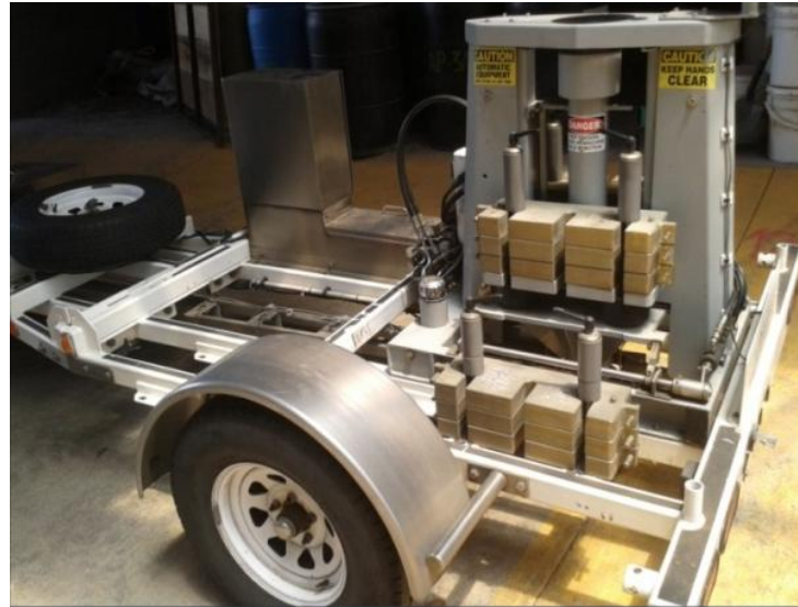
Figura 5. Deflectómetro de impacto (FWD) LanammeUCR Fuente: LanammeUCR, 2008
