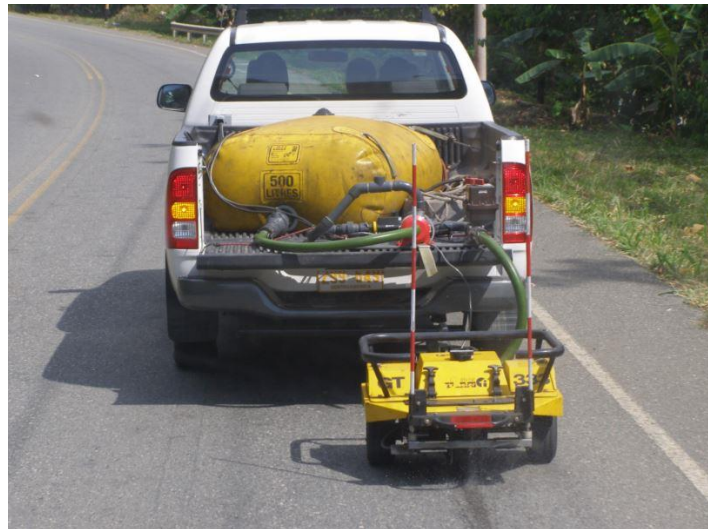
Figura 7. Griptester del LanammeUCR Fuente: LanammeUCR, 2019
