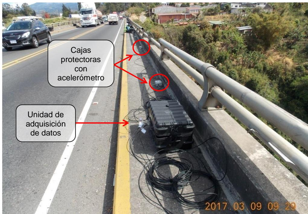
**Figura 5.** Colocación de sensores sobre las aceras del puente. Nótese que el monitoreo no interrumpe el tránsito de vehículos
