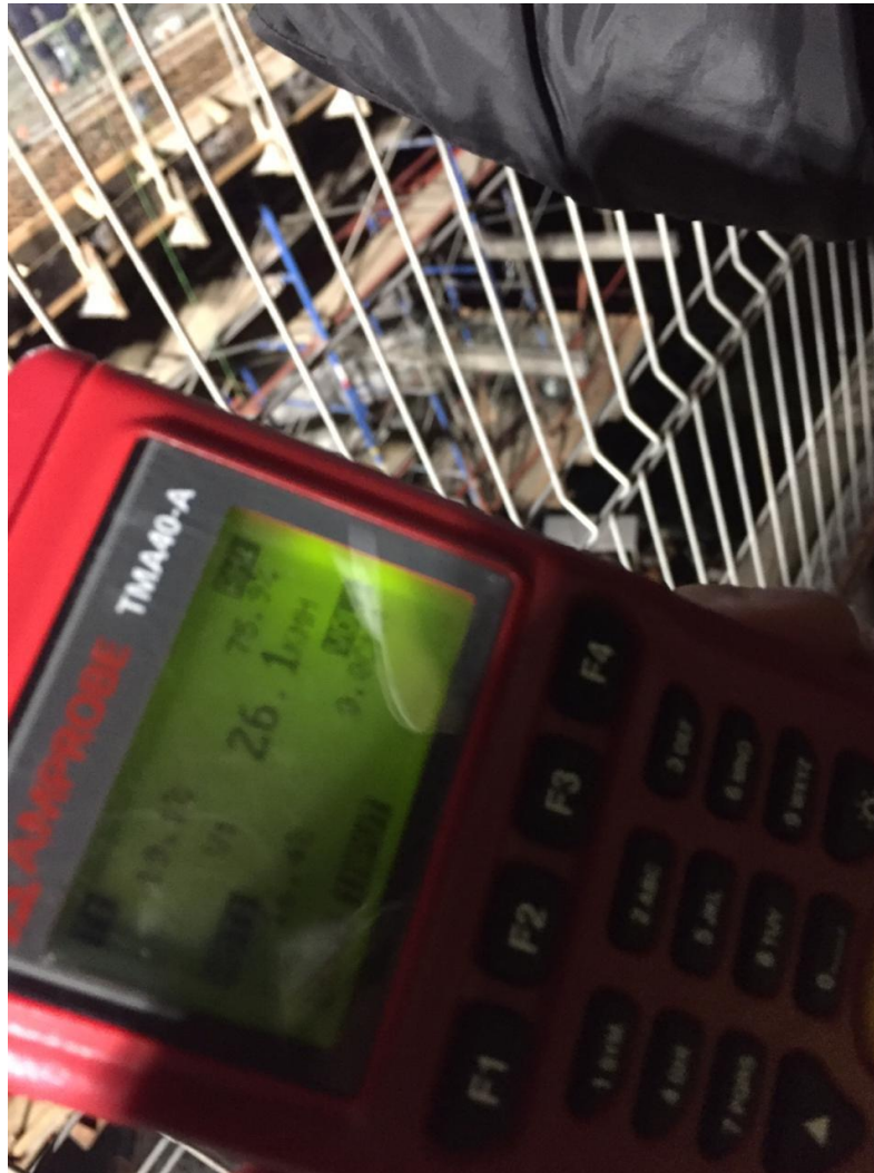
Fotografía 4. Medición de condiciones ambientales (Temperatura del aire, humedad relativa y velocidad de viento). Fecha de la fotografía: 10 de diciembre de 2019 Fuente: LanammeUCR
