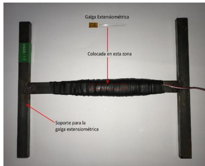
Figura 4. Galga extensiométrica, cuarto de puente de 120Ω
