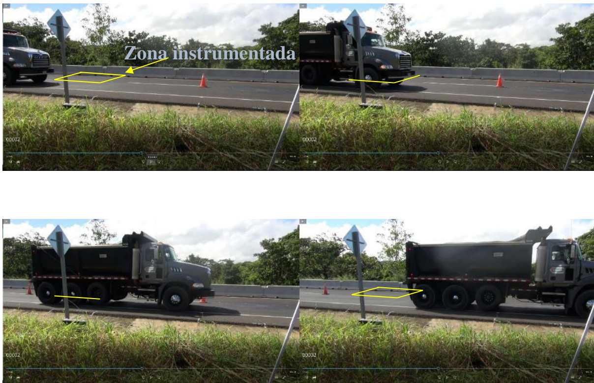
Figura 41. Paso de vehículo con carga patrón en zona instrumentada
