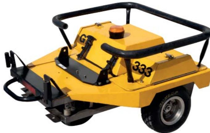
*Figura 4.* GRIP Tester para medir la resistencia al deslizamiento
