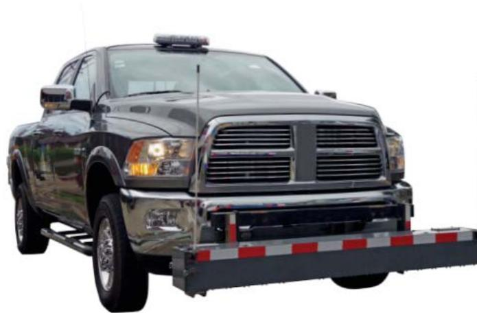
Figura 3. Perfilómetro Láser para determinar el perfil y macrotexturas en el pavimento
