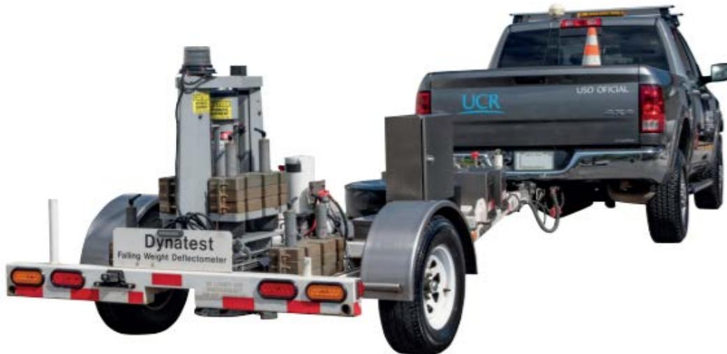
**Figura 2.** Deflectómetro de impacto para medir deformaciones en el pavimento
