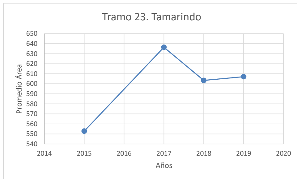
Figura 104. Deflectometría Tramo #23 Tamarindo
