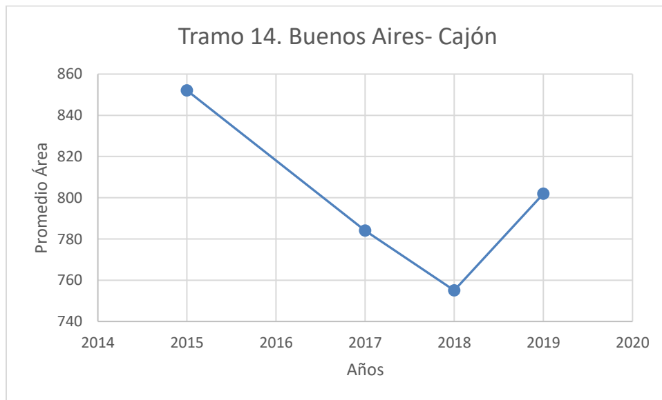
Figura 95. Deflectometría Tramo #14 Buenos Aires-Cajón
