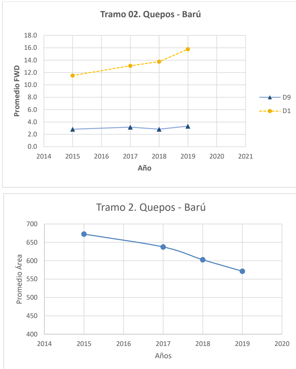
Figura 83. Deflectometría Tramo #2 Quepos-Barú
