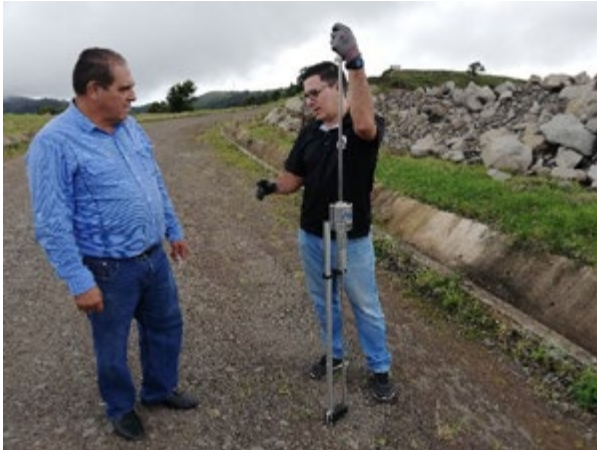
Figura 6: Capacitación del uso del DCP y evaluación de una base granular de un camino municipal
