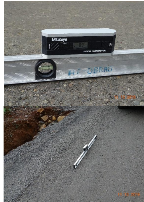
Fotografía 21. Márgenes de la ruta sin revestir en sección de ruta con pendiente de 15,66%. Ubicación: Ruta Nacional 334, km 7+490. Sección de control 11050, Angostura (cementerio) - Repunta (RN2). Fecha: 13 de noviembre de 2019. Fuente: LanammeUCR
