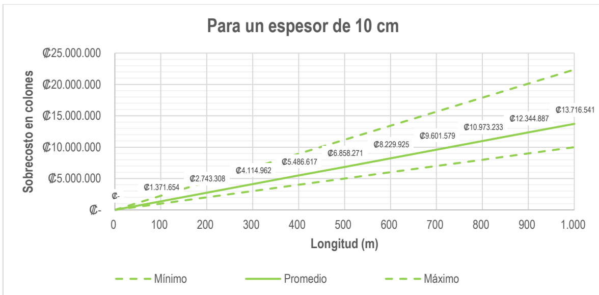
Figura 5. Para un ancho de carril de 3,5 m y una profundidad de 10 cm, este gráfico representa el sobre costo que representa para la Administración el hecho de colocar mezcla asfáltica mediante el ítem de bacheo a profundidad parcial, con respecto a la colocación de mezcla mediante el ítem de pavimento bituminoso en caliente y perfilado de pavimentos, para diferentes longitudes de tramo. Fuente: Unidad de Auditoría Técnica del LanammeUCR.
