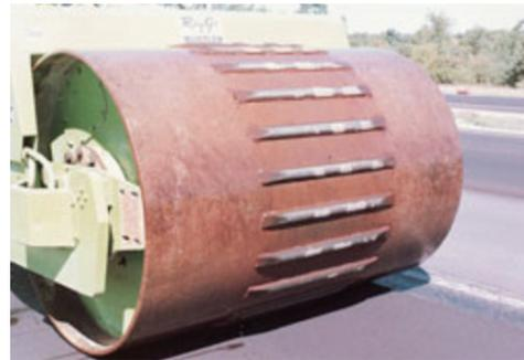
Figura 10. Conformación de bandas sonoras mediante amasado.
