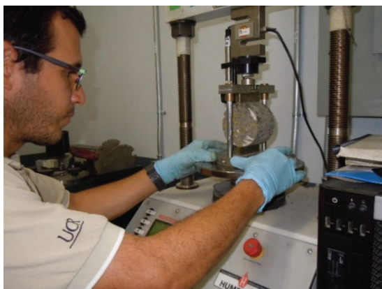
Figura 16. Falla a tensión indirecta.
