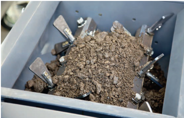
Figura 13. Mezcladora tipo “pugmill” (Wirtgen, 2012).
