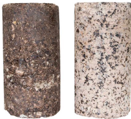
Figura 1. Material estabilizado con emulsión asfáltica (izquierda) y con asfalto espumado (derecha) por Daniela Martínez Ortiz. 2019.
