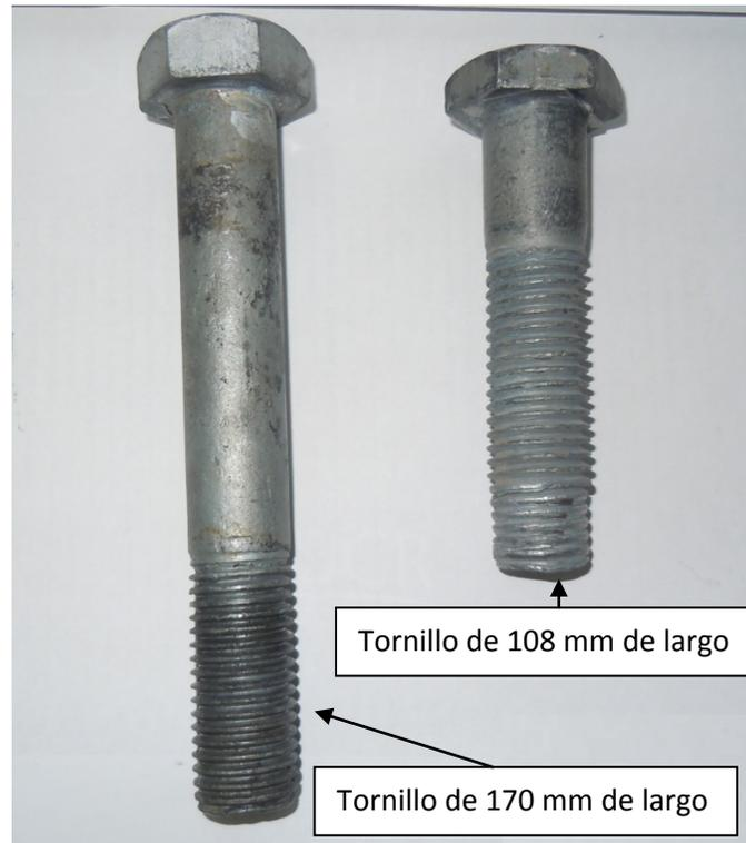
**Figura No. 2.** Tipos de tornillos del puente modular que se utilizaron en los ensayos.
