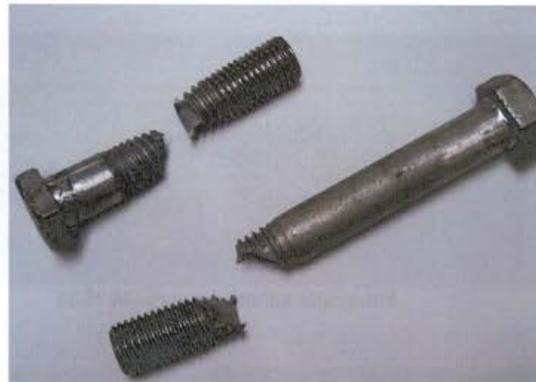
Fotografía 7. Falla típica de sección de rosca. Muestras 334-13 y 335-13
