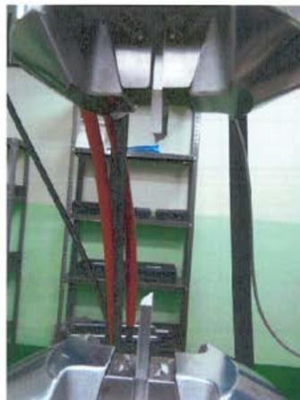
Fotografía 3: Probeta 0189-13 fallada en la máquina MTS
