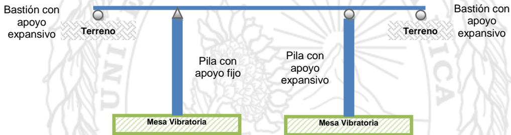
Figura 13. Esquema de un puente de tres tramos con una única pila formando parte del sistema sismo-resistentes
