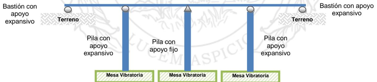
Figura 14. Esquema de un puente de cuatro tramos con una única pila formando parte del sistema sismo-resistentes
