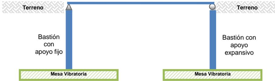
Figura 12. Esquema de un puente con un único bastión formando parte del sistema sismo-resistentes
