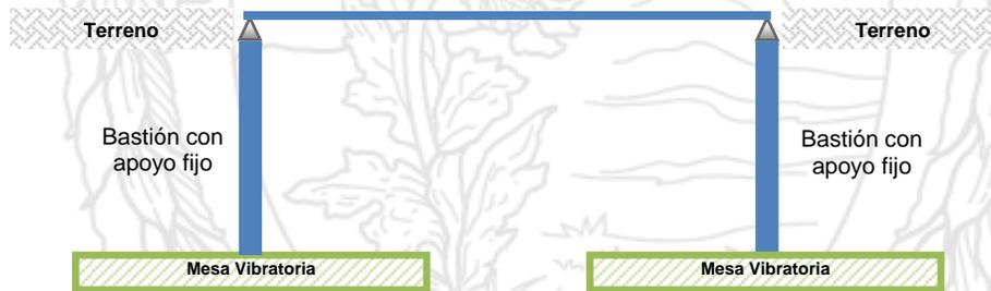
Figura 11. Esquema de un puente con ambos bastiones formando parte del sistema sismo-resistentes
