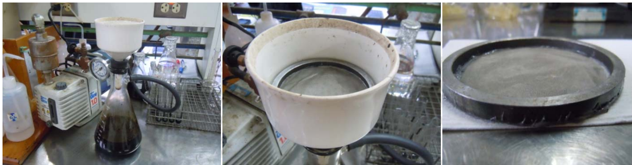
Figura 1. Equipo para filtrado al vacío similar al PAT publicado en el NCHRP proyecto 9-10
