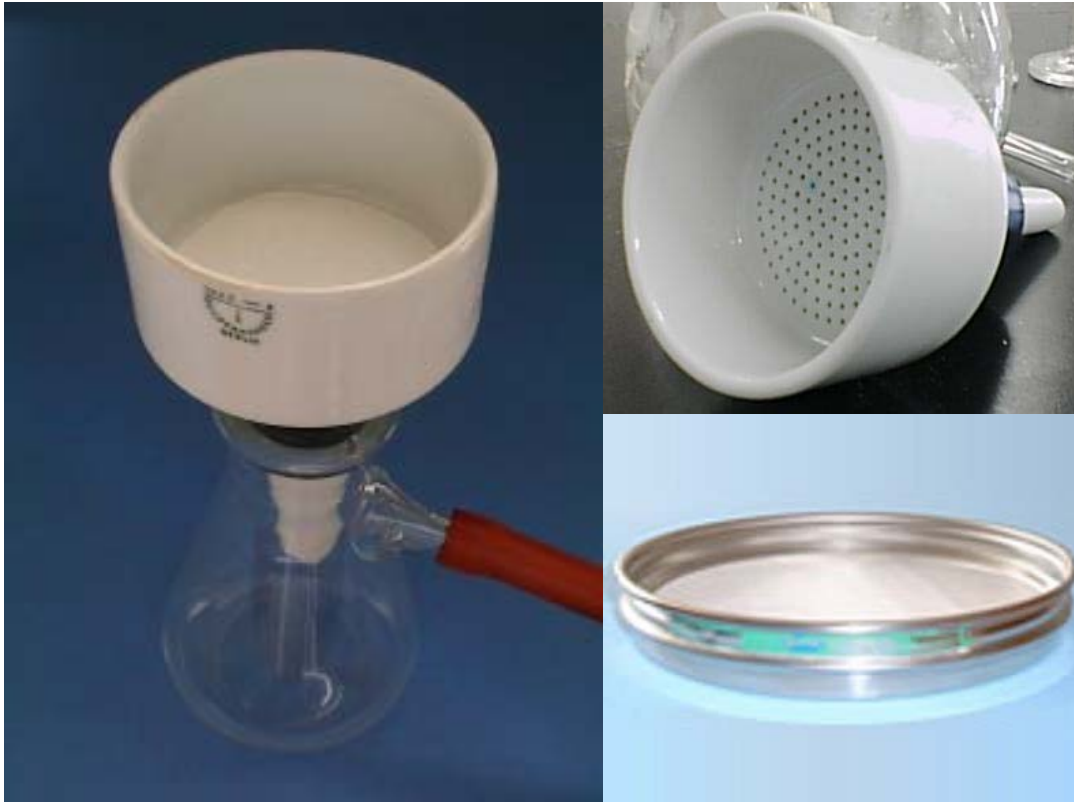
Figura A1. Equipo para filtración al vacío mediante un filtro de tamiz de 75 \mu\text{m} y 7 mm de altura.
