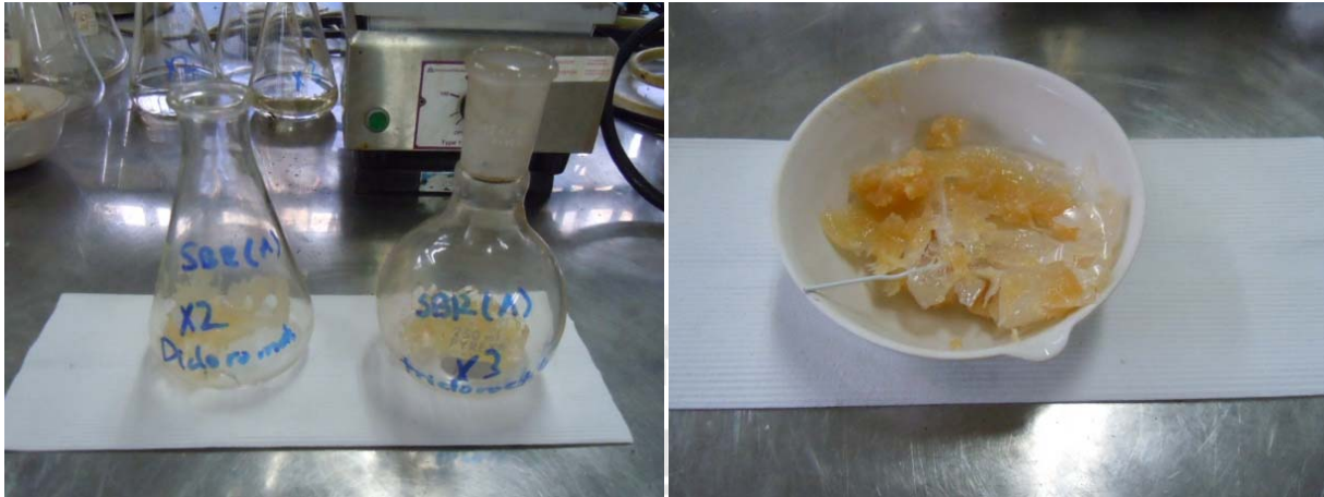
Figura 4. Prueba de solubilidad en diferentes solventes para el polímero látex SBR (A)
