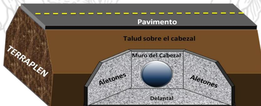
**Figura N°14.** Componentes estructurales de las alcantarillas considerados para determinar su vulnerabilidad.
