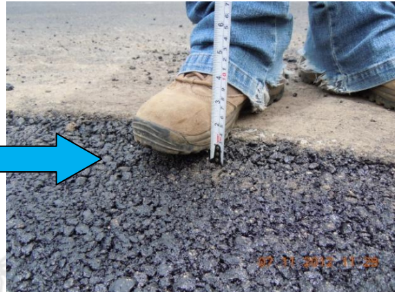
Fotografía 29. Medida de espesor de 3cm. Ubicación: Ruta Nacional 136, intersección con Ruta Nacional 3. Fecha: 11 de julio de 2012.
