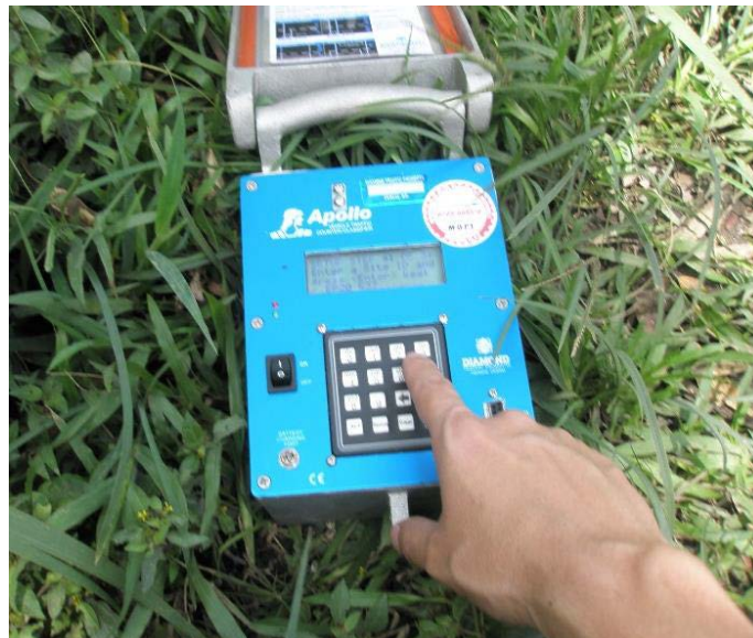
Figura 2. Contador electrónico Fuente: MOPT, 2018
