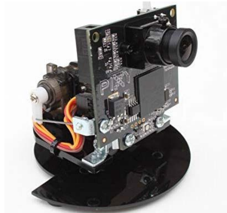
Figura 7. Ensamble PixyCam Pan/Tilt Fuente: Pixy, 2019
