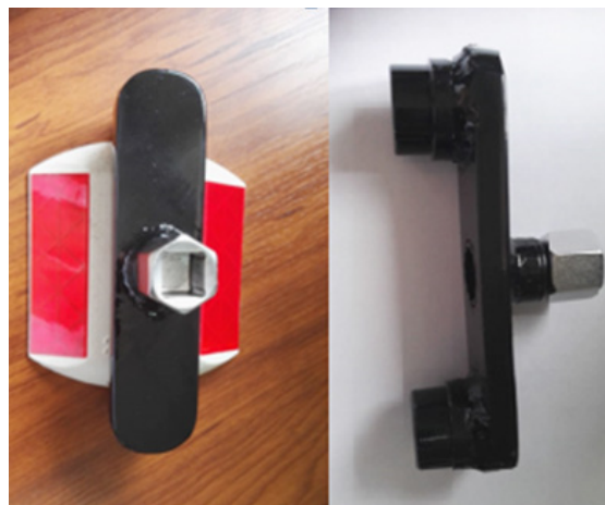
Figura 3. Herramienta utilizada para la transición entre el torquímetro y el captaluz
