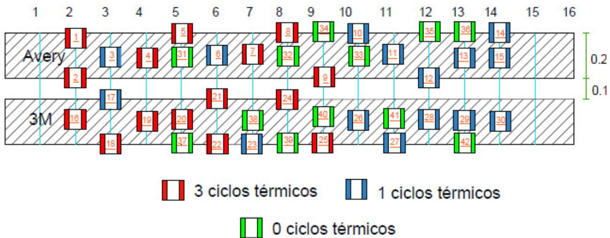
Figura 2. Diagrama metodológico para la colocación de captaluces en la pista del HVS, según pretratamiento del bituminoso
