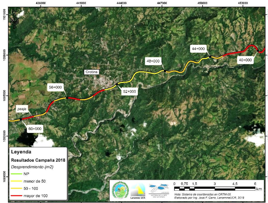
Figura A5 19 Presencia de Desprendimiento de agregado, Ruta Nacional 27, sentido Caldera – San José, Est. 40+000 - 60+000
