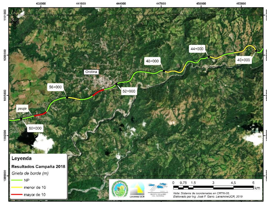
Figura A5 31 Presencia de Grietas de borde, Ruta Nacional 27, sentido Caldera – San José, Est. 40+000 - 60+000
