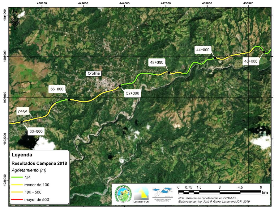
Figura A5 23 Presencia de Agrietamiento, Ruta Nacional 27, sentido San José – Caldera, Est. 40+000 - 60+000
