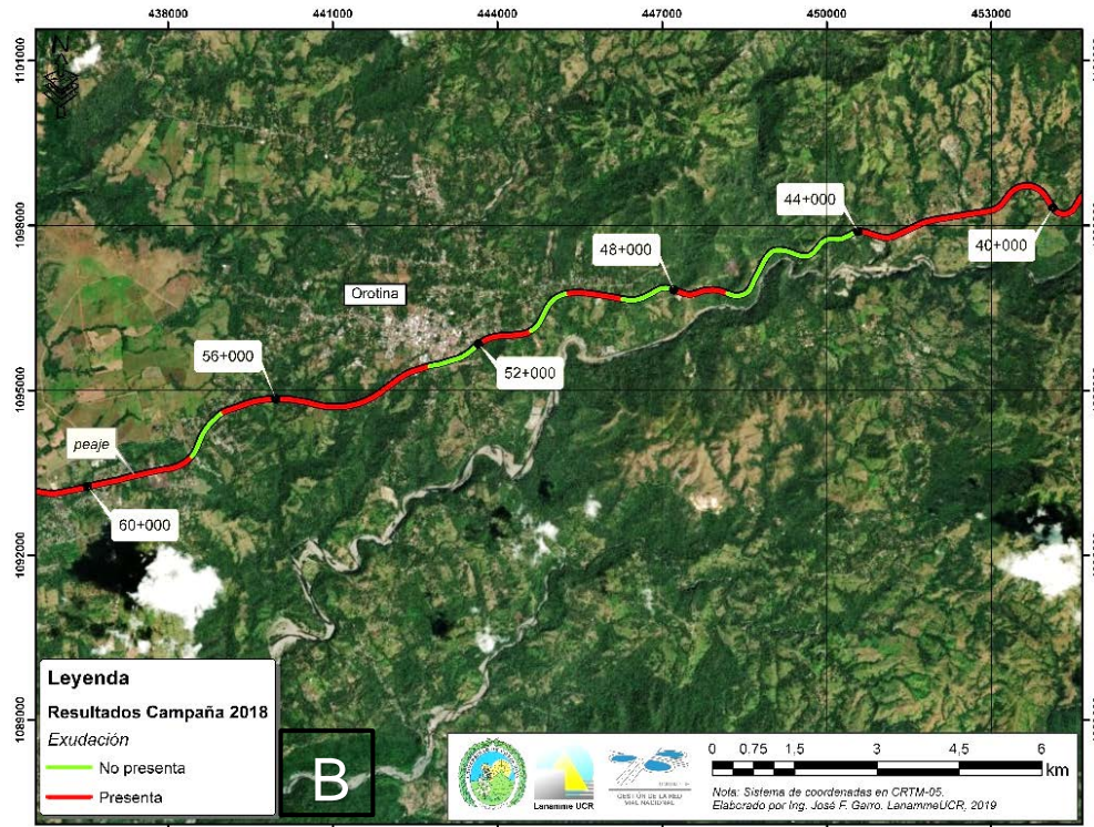
Figura 27: Ubicación de tramos con presencia de exudación. A) San José - Caldera, B) Caldera - San José
