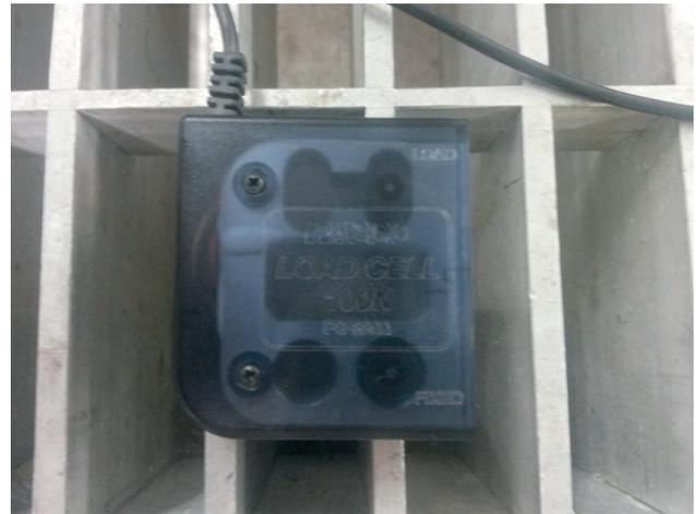
**Figura 6. Celda de carga de PASCO**
