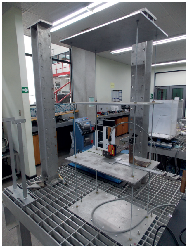
Figura 14. Colocación del modelo y sensores para medición de K_1
