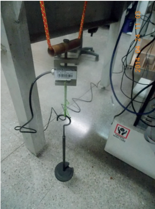
Figura 12. Calibración de la celda de carga
