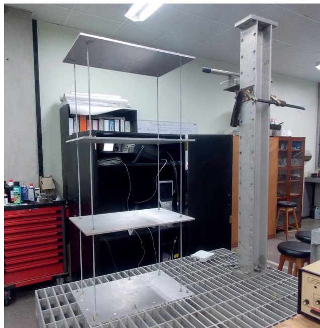
Figura 3. Modelo tridimensional anclado a la mesa de pruebas
