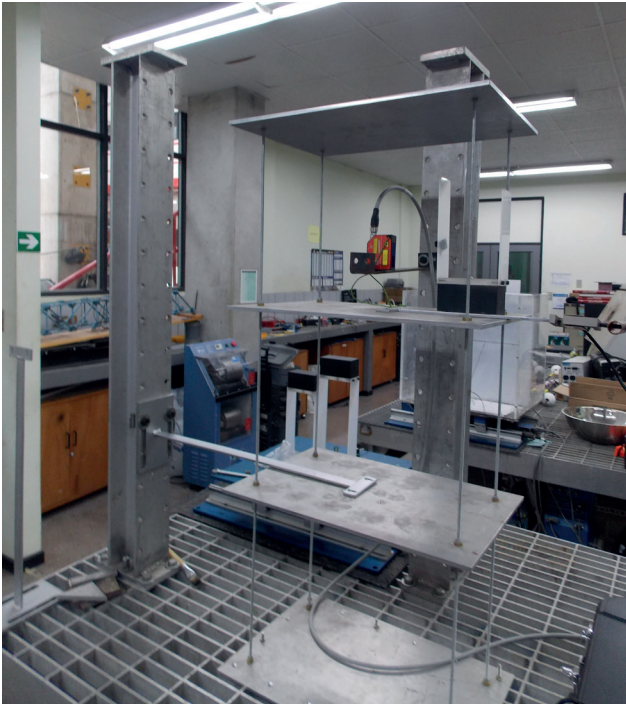
Figura 15. Colocación del modelo y sensores para medición de K2
