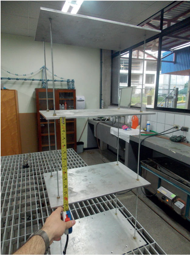
Figura 7. Medición del espaciamento entre placas del modelo
