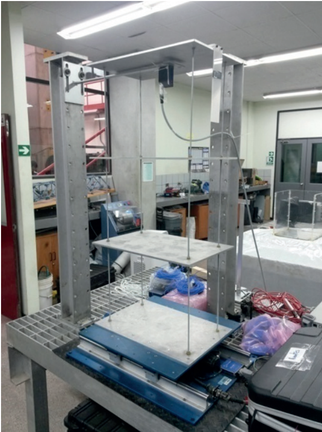
Figura 18. Colocación de sensores para medición de amortiguamiento con vibración forzada
