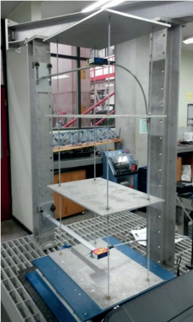
Figura 19. Colocación de los dos láser para medición de desplazamiento relativo
