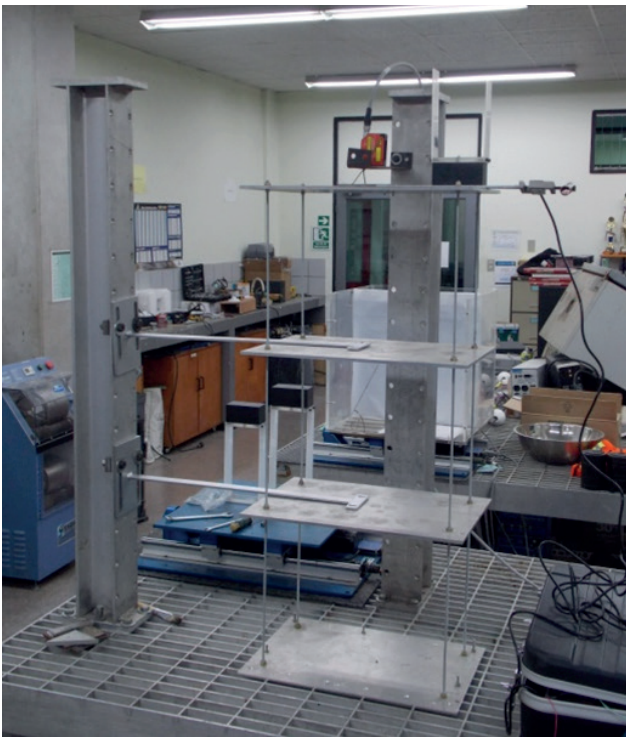
Figura 16. Colocación del modelo y sensores para medición de K3
