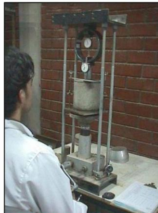
**Figura 8.** Equipo para ensayo de CBR en laboratorio
