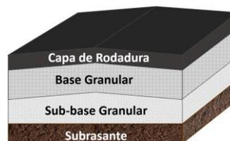
**Figura 5.** Ejemplo de estructura de pavimento
