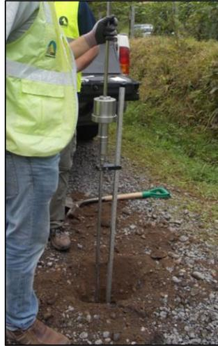
**Figura 9.** Prueba de CBR en sitio con el DCP
