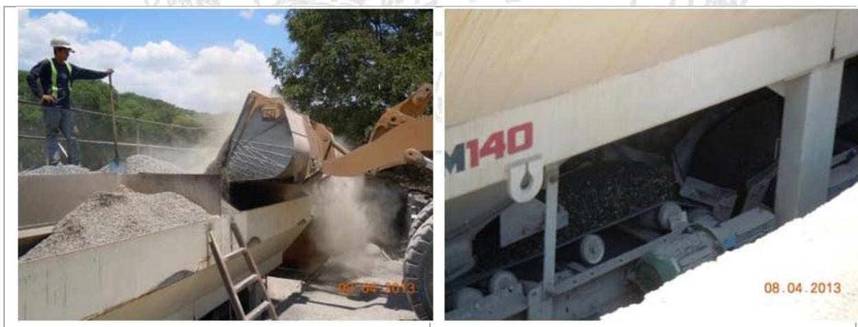
**Fotografía 2** Tolvas de dosificación de agregados.
