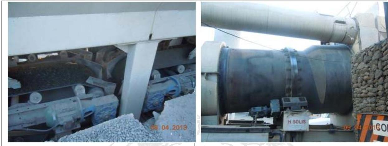
**Fotografía 3** Fajas de transporte de agregados y tambor secador.
