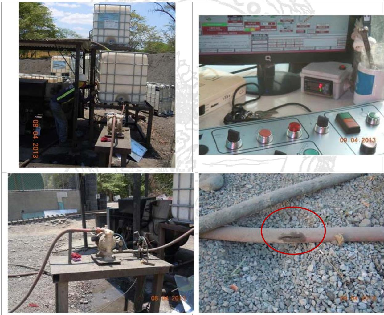
**Fotografía 8** Sistema de dosificación de aditivo al asfalto, problemas con una manguera para aire a presión, (abril 2013).
