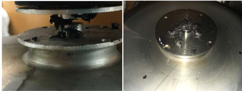
Figura 20. Muestra de betún fracturado luego del ensayo de Fatiga a Esfuerzo Controlado
