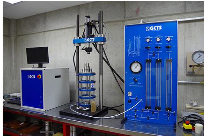
Figura 18. Equipo triaxial para resistencia al corte.
