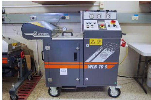
Figura 7. Cámara de expansión para espumar el asfalto (equipo WLB 10S).
