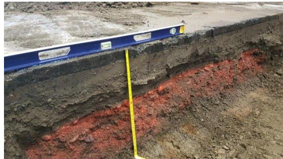
Durante el proceso de corte, al preparar la sección de análisis se colocó pintura en la mayor parte de la zona correspondiente a la sub-base.
