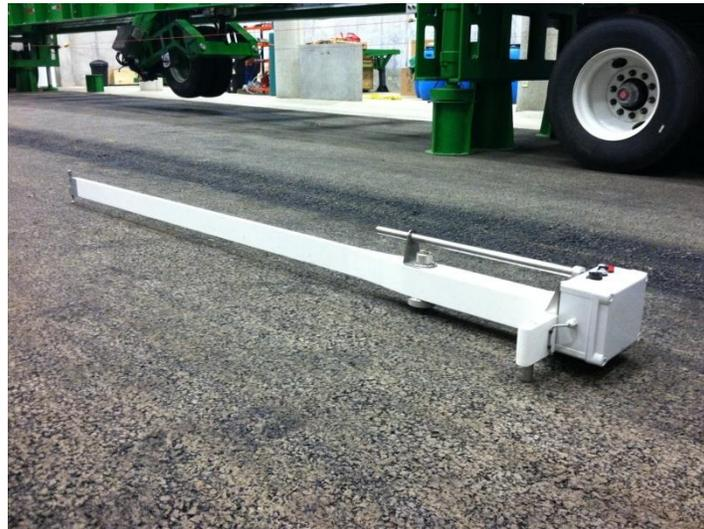
Figura 40. Deflectómetro de superficie del pavimento.
