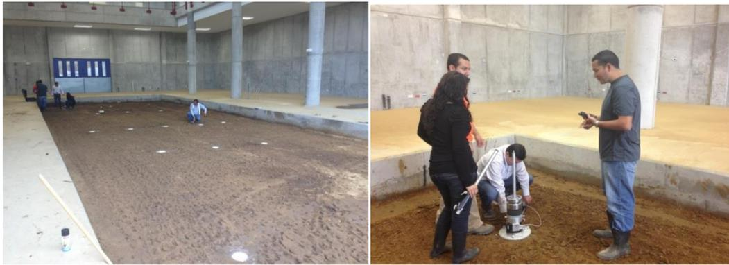
Figura 18. Puntos para realizar pruebas con el deflectómetro.
