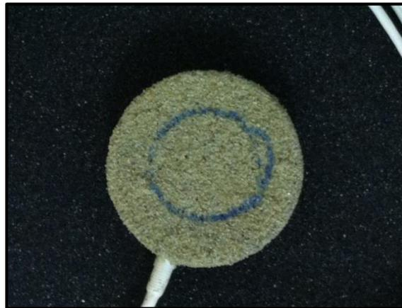
Figura 37. Transductor para medición de presión
