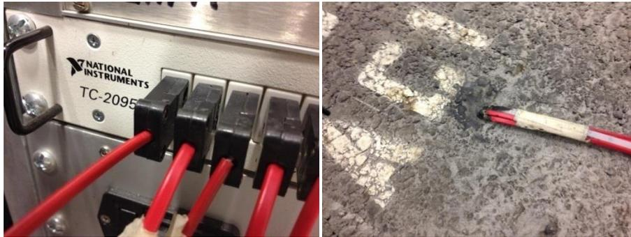
Figura 41. Termocuplas instaladas en los tramos
