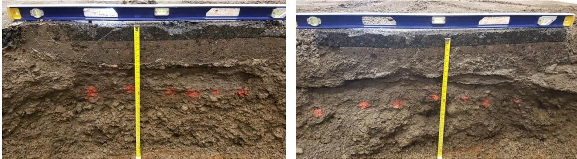
Se marca con pintura el inicio de la sub-base, por encima de los puntos de pintura está la base estabilizada. El proceso de corte se mejoró respecto al corte anterior, de manera que la base estabilizada se cortó con la retroexcavadora y la capa de sub-base se cortó y retiró a mano hasta alcanzar el suelo de la subrasante, esto permitió apreciar mejor la condición de las capas inferiores.
