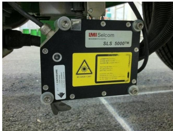
Figura 35. Perfilómetro láser (RSP).
