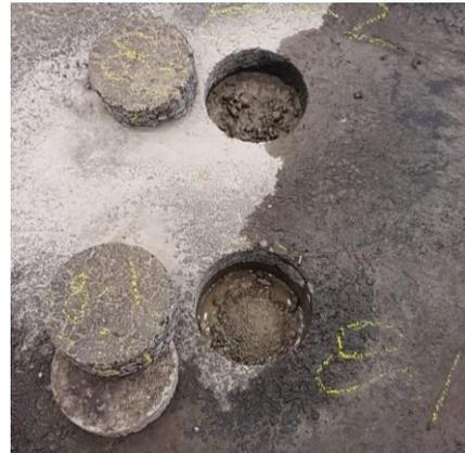
Se extrajeron 20 núcleos de seis pulgadas de la estructura, 10 en cada uno de los tramos y distribuidos a lo largo del tramo. Algunos de los mismos se lograron extraer con una parte de la base estabilizada unida a la mezcla asfáltica. Estos núcleos serán pasados a laboratorio para medir sus características (dimensiones, volumetría, contenido de asfalto y otras propiedades).
