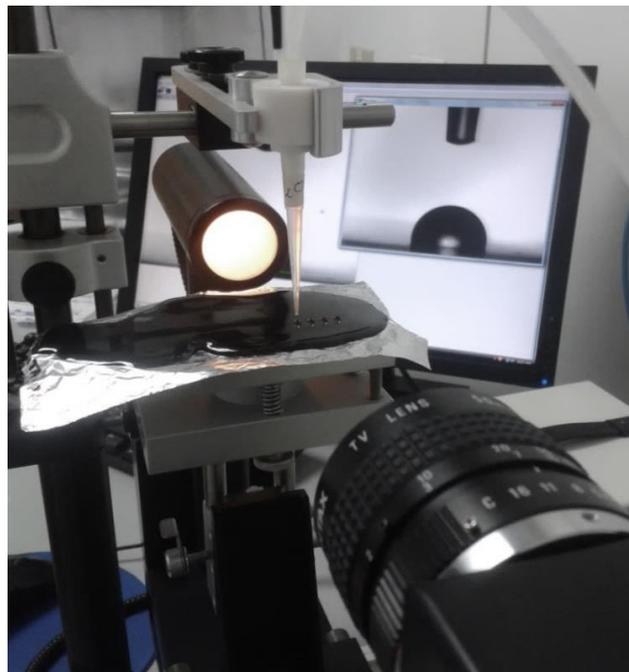
**Figura 3.** Medición de ángulos de contacto utilizando el goniómetro (40)
