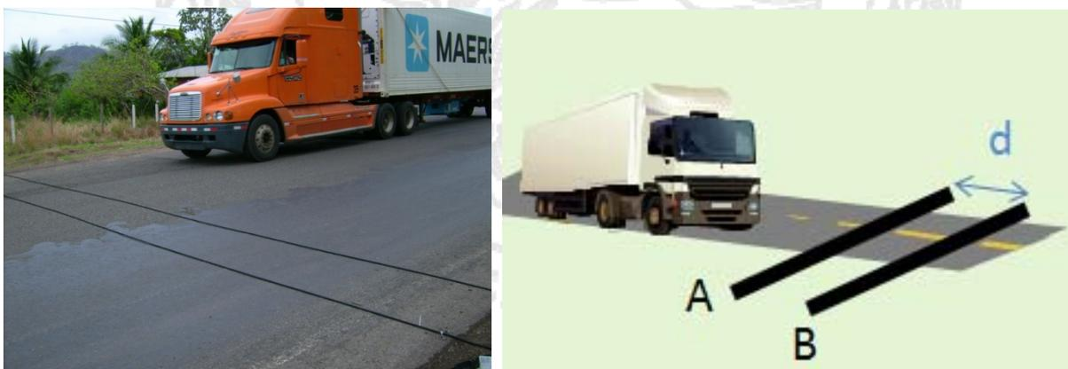
**Figura 2.** Esquema de colocación de mangueras neumáticas en el pavimento
