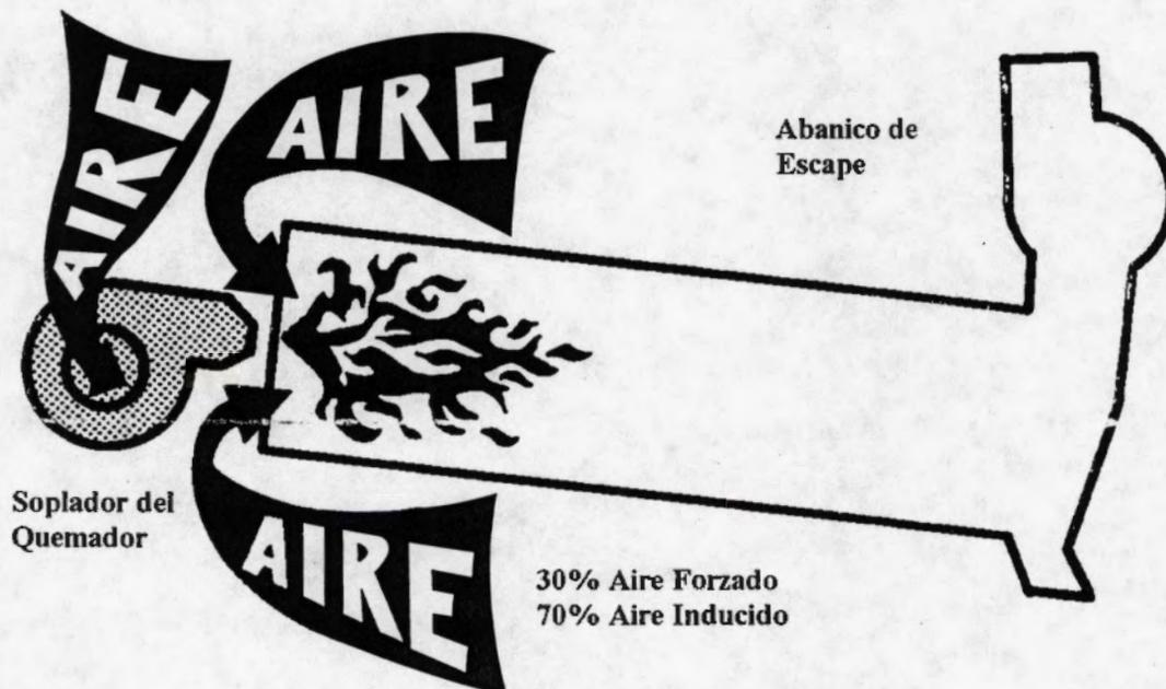
Según el tipo de alma del quemador la temperatura excede los 1371 °C y como el aire inducido empieza a fluir alrededor de la flama su temperatura se incrementa rápidamente hasta cerca de los 760 °C. A esta temperatura se secan los agregados.
