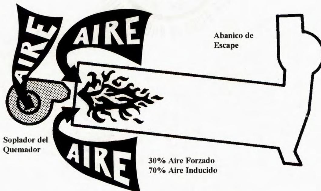
Según el tipo de alma del quemador la temperatura excede los 1371 °C y como el aire inducido empieza a fluir alrededor de la flama su temperatura se incrementa rápidamente hasta cerca de los 760 °C. A esta temperatura se secan los agregados.
