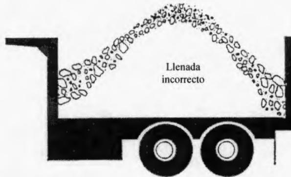
**a) Cargado en mediante vertido simple, el cual produce segregación alrededor de todos los extremos de la góndola del camión.**
