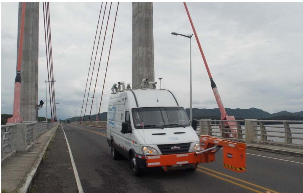
**Figura 48:** GPR con antena de 2GHz utilizada en el puente La Amistad de Taiwán.
