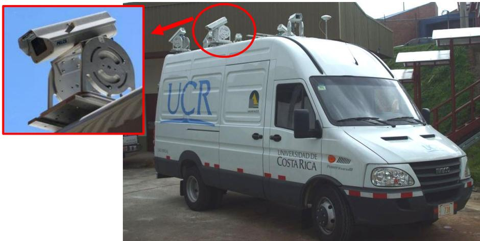
Figura 5: Equipo de Imágenes Georeferenciadas del LanammeUCR.
