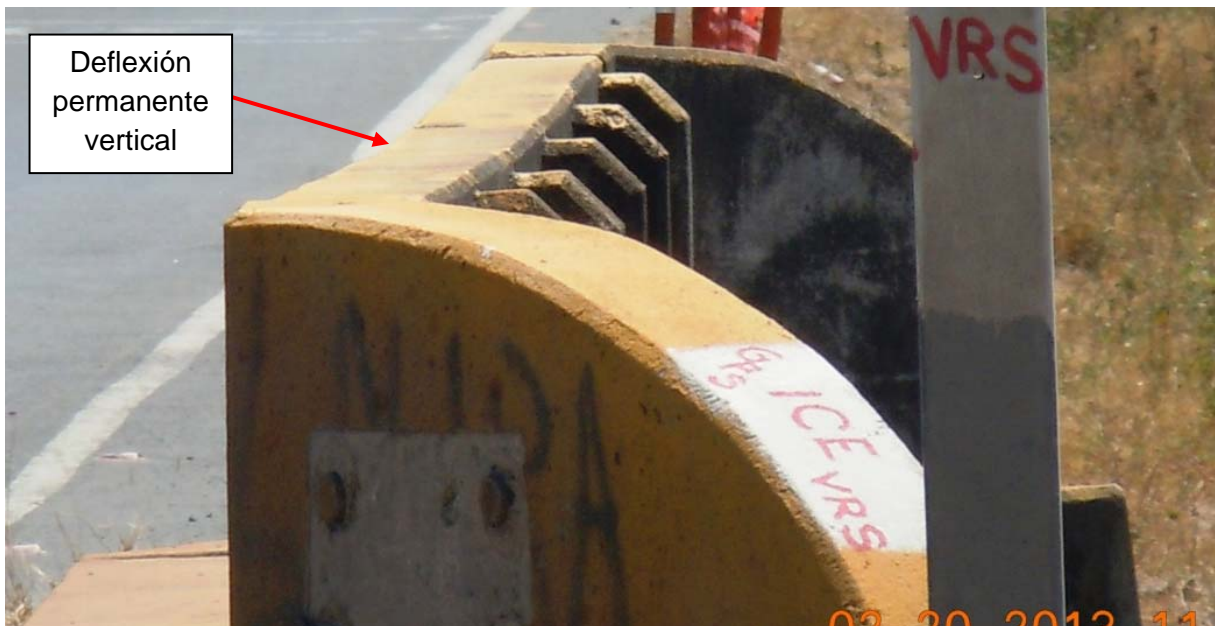
Figura 7: Deflexión vertical permanente de la barrera.
