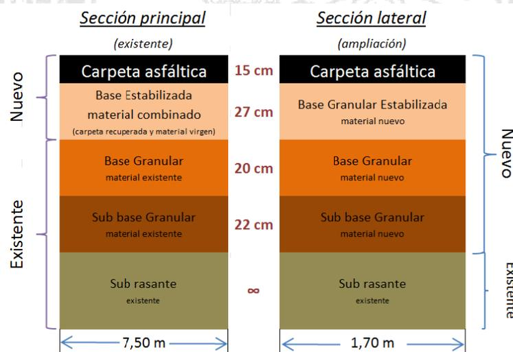
**Figura 4.** Detalle de cada una de las secciones rehabilitadas en el proyecto.
