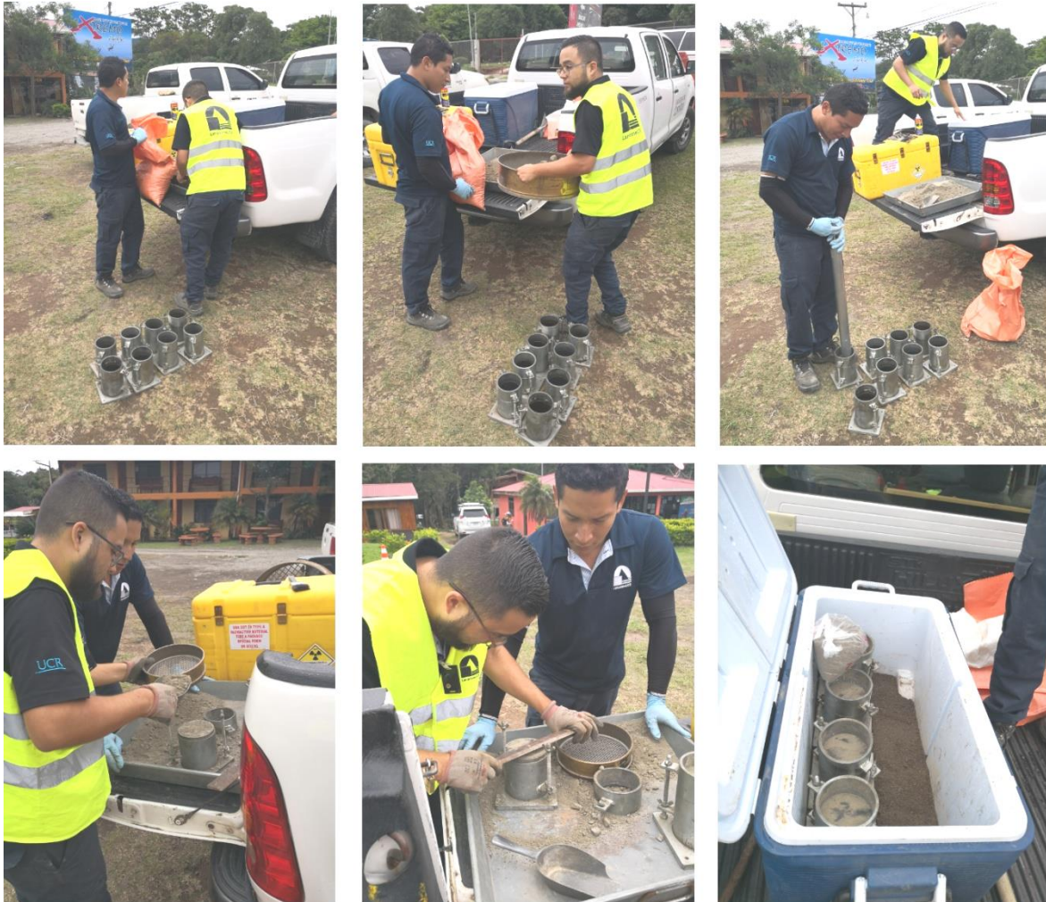
Figura 9. Preparación de muestras en campo por los técnicos del LanammeUCR.
