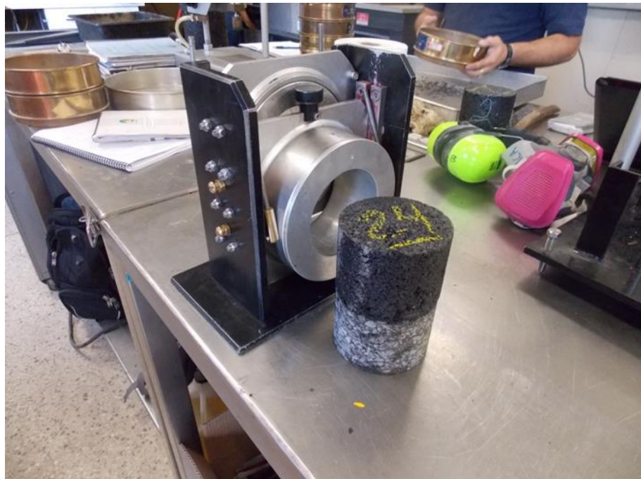
Figura 36. Espécimen y Dispositivo de ensayo utilizado para la evaluación de la adherencia de los riegos de liga.
