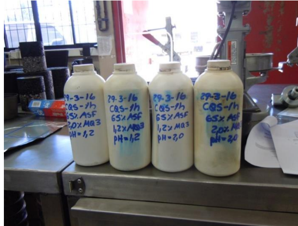
Figura 24. Diseño de emulsión CQS-1H, diferentes combinaciones de cantidad de emulsificante y pH
