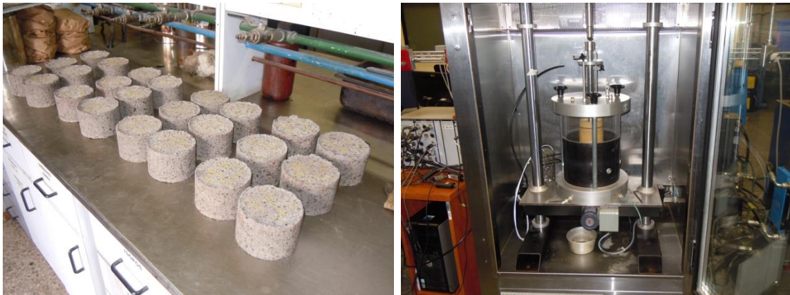
Figura 29. Ensayos de diseño para estabilización de bases granulares asfalto espumado.
