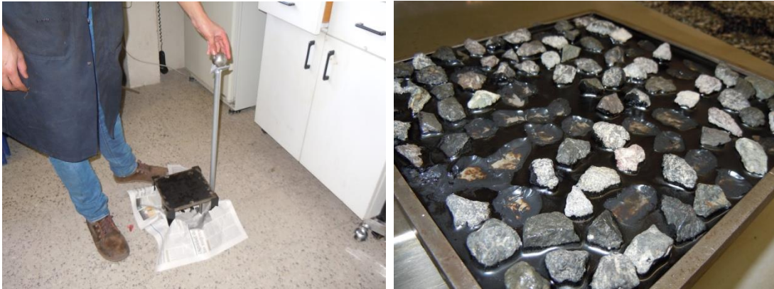
Figura 33. Pruebas de Vialit en tratamientos superficiales.
