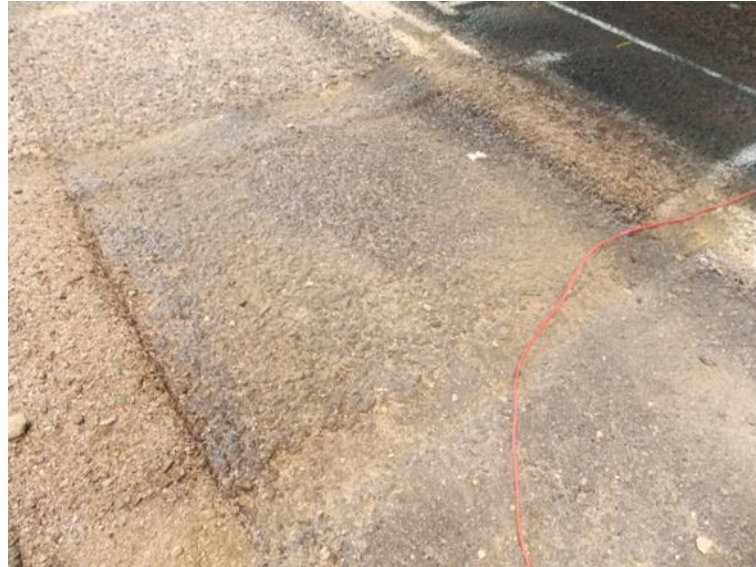
Figura 38. Bache evaluado en el Simulador de Vehículos Pesados (HVS).
