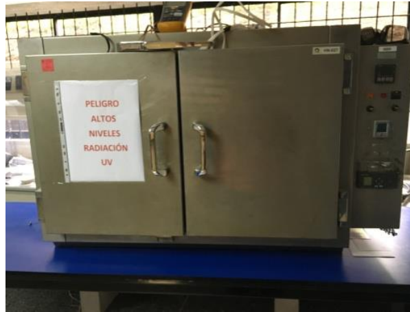
Figura 10. Dispositivo de oxidación acelerado con condiciones controladas de temperatura, humedad y radiación ultravioleta..
