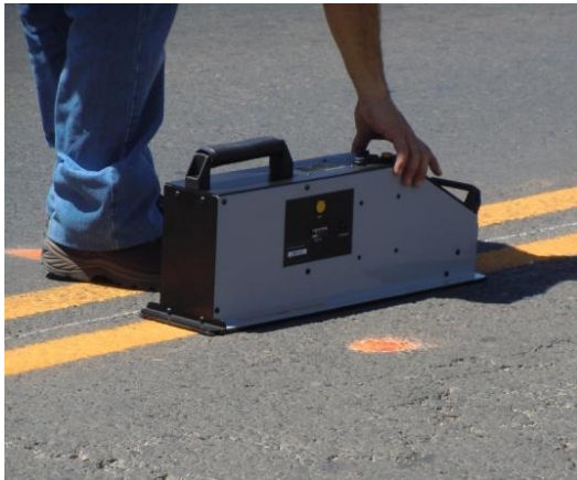
Figura 61. Medición de retroreflectividad en demarcación horizontal.
