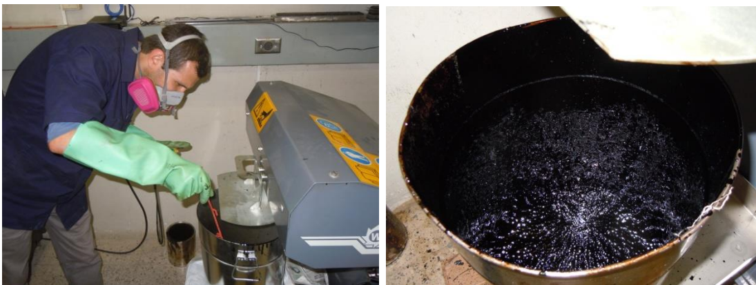
Figura 27. Calibración del asfalto para obtener el máximo espumado.
