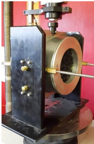
Figura 42. Dispositivo de ensayo de corte directo ALDOT-430 modificado
