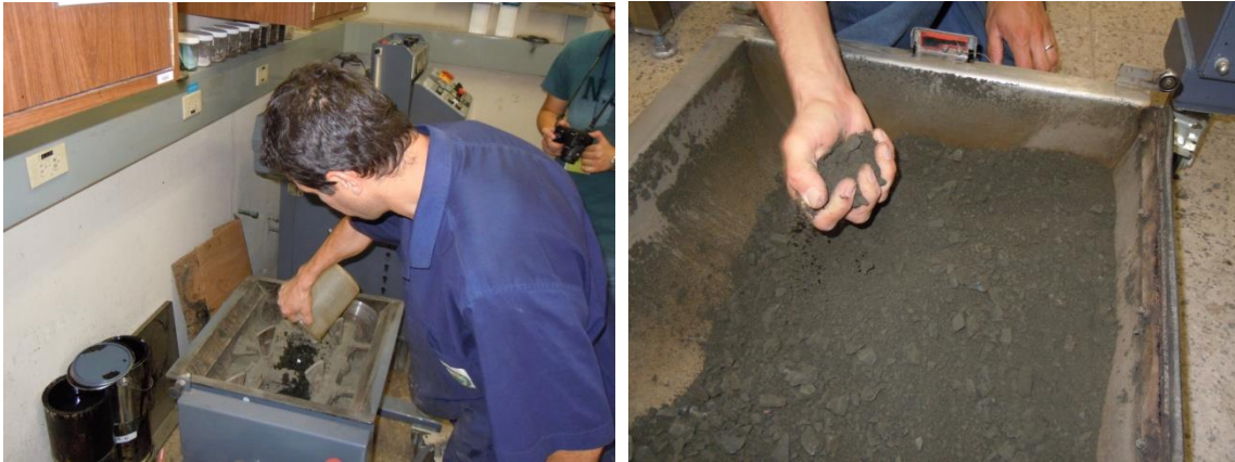
Figura 28. Preparación de mezcla para estabilización de bases granulares asfalto espumado.
