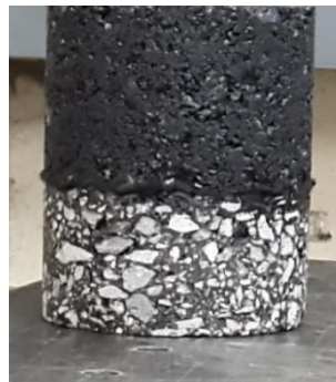
Figura 41. Espécimen de dos capas de mezcla asfáltica unida con ligante asfáltico utilizando geosintético
