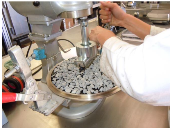
Figura 32. Pruebas de barrido en tratamientos superficiales
