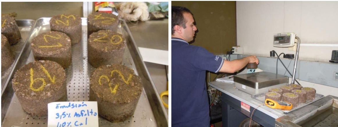
Figura 31. Especímenes con material de base estabilizada con emulsión
