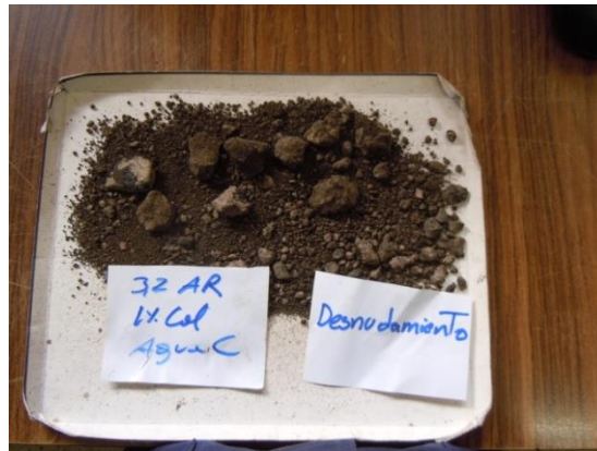
Figura 30. Pruebas de recubrimiento, para determinación inicial de fluidos totales.
