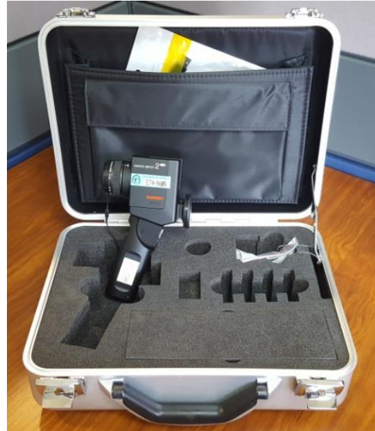
Figura 67. Equipo para la medición de la luminancia.
