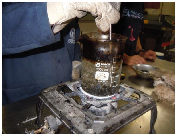
Figura 26. Ensayos para medición de adherencia para su aplicación en mezclas en frío, microcapas y tratamientos superficiales.
