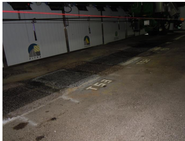
Figura 34. Tratamientos simples, de dos y tres capas colocados en el HVS.
