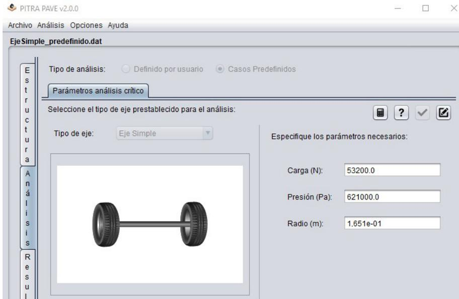
Figura 10. Modelación de un simple, en software de multicapa elástica
