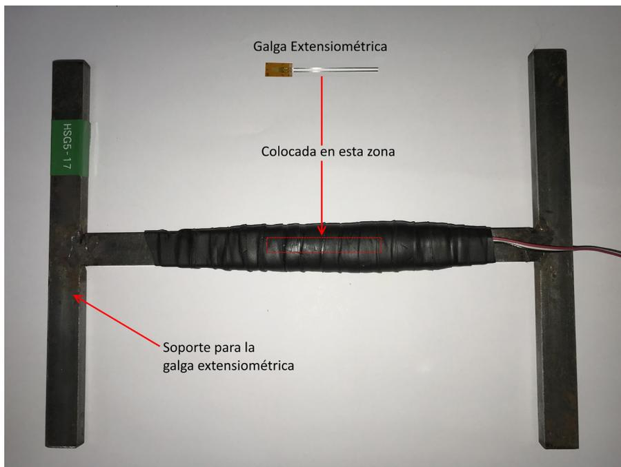
Figura 3. Galgas extensiométricas para pavimentos rígidos
