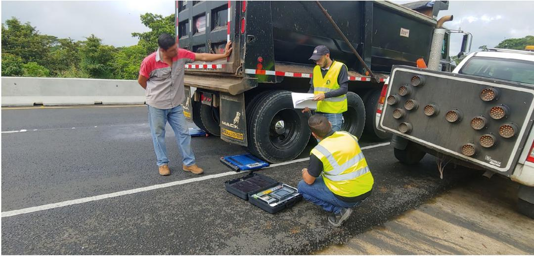
Figura 6. Pesaje y verificación de carga en el vehículo patrón
