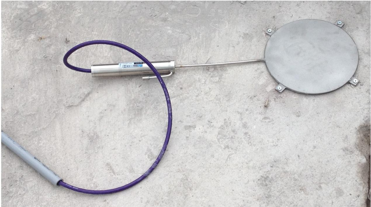
Figura 2. Celda de presión para medición de esfuerzos verticales
