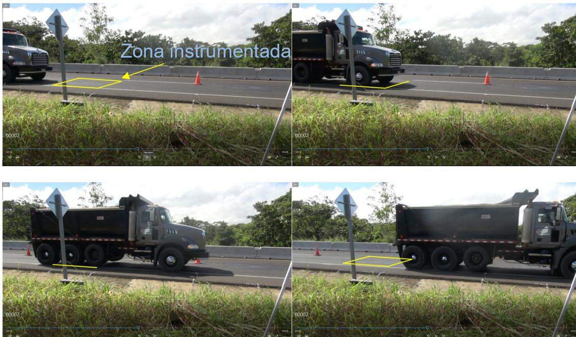
Figura 7. Paso de vehículo con carga patrón en zona instrumentada
