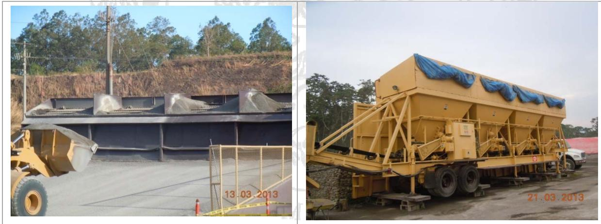
**Fotografía 2a y 2b** Tolvas de dosificación de agregados
