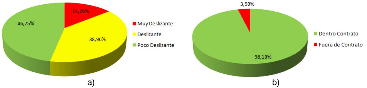
Figura 12: Resultados de las pruebas de a) *Grip Tester* y b) *Mu Meter*, para el sentido de venida. Los rangos del *Mu Meter* corresponden a los indicados en el contrato.
