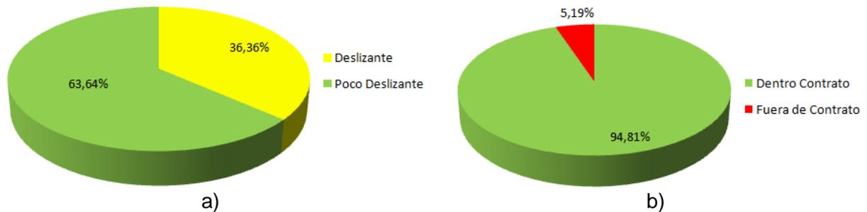
Figura 11: Resultados de las pruebas de a) *Grip Tester* y b) *MuMeter* para el sentido de ida. Los rangos del *Mu Meter* corresponden a los indicados en el contrato.
