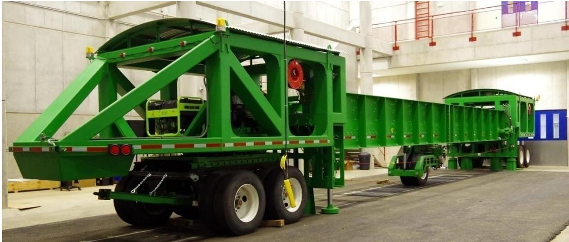
Figura 5. Simulador de Vehículos Pesados (HVS) del LanammeUCR.
