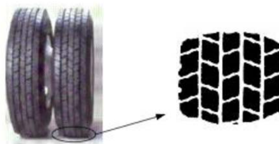
Figura 24. Huella de neumático en un eje de llanta dual
