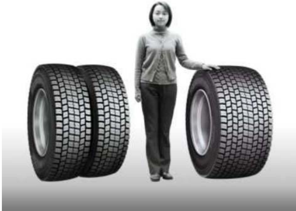
Figura 6. Comparación de neumáticos duales y un supersingle
