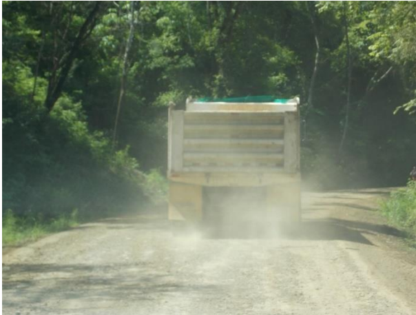
Fotografía 3. Vagoneta sin lona de protección. Ubicación: Sobre la Ruta 163, km 4+385 desde el cruce con la Ruta 21, Sección de control 60921:Jicaral(R.21)-Dominicana(Iglesia). Fecha 30 de mayo de 2018. Fuente: UAT-LanammeUCR.
