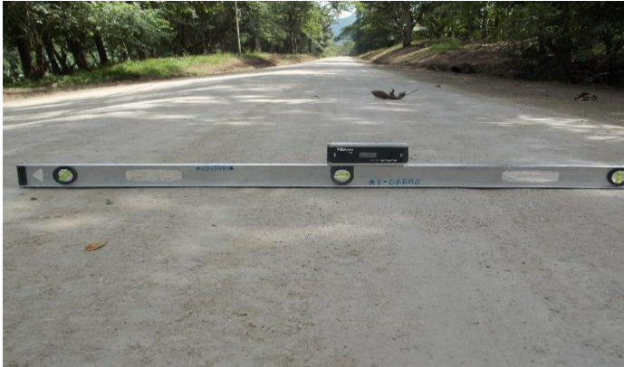
Fotografía 13. Medición de pendientes transversales en tramo mejorado con cemento. Ubicación: Sobre la Ruta 163, km 9+200 desde el cruce con la Ruta 21, Sección de control 60922: Dominicana (Iglesia)-Lte. Provincial Puntarenas/Guanacaste (Río Juan de León). Fecha 03 de setiembre de 2018. Fuente: UAT-LanammeUCR.
