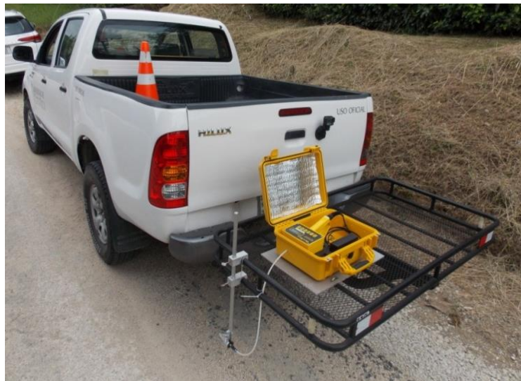
Fotografía 35. Monitor ambiental Dustmate adaptado a vehículo liviano para medición de polvo emitido por el tránsito vehicular. Fuente: UAT-LanammeUCR.
