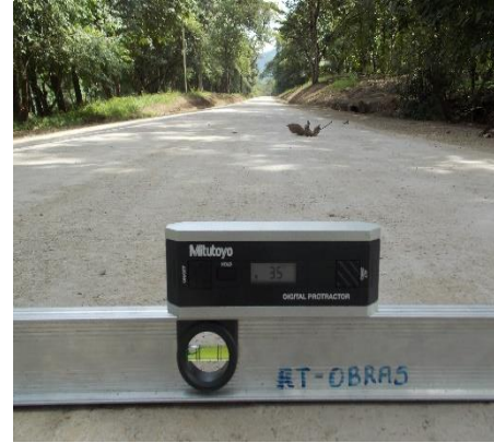
Fotografía 13. Medición de pendientes transversales en tramo mejorado con cemento. Ubicación: Sobre la Ruta 163, km 9+200 desde el cruce con la Ruta 21, Sección de control 60922: Dominicana (Iglesia)-Lte. Provincial Puntarenas/Guanacaste (Río Juan de León). Fecha 03 de setiembre de 2018. Fuente: UAT-LanammeUCR.
