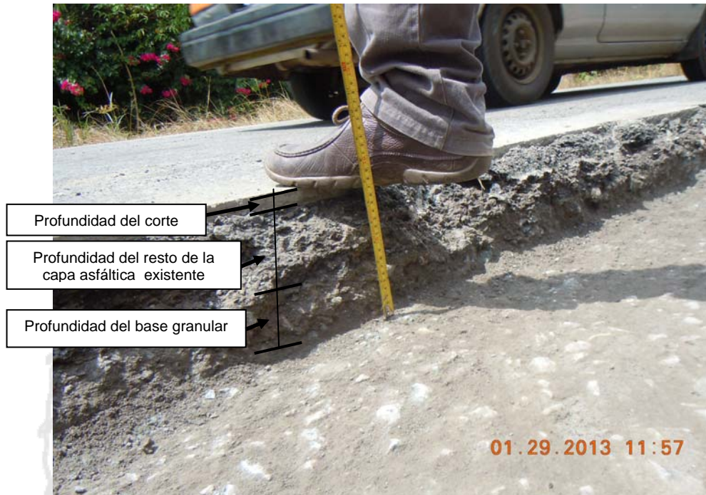
Fotografía 8: Zona 4-1 Pérez Zeledón, Profundidad máxima del bache. El corte es parcial. Ubicación: Ruta Nacional No.2, sección La Ese - San Isidro. Fecha: 29 de enero del 2013. Fuente: Unidad de Auditoría Técnica, LanammeUCR.
