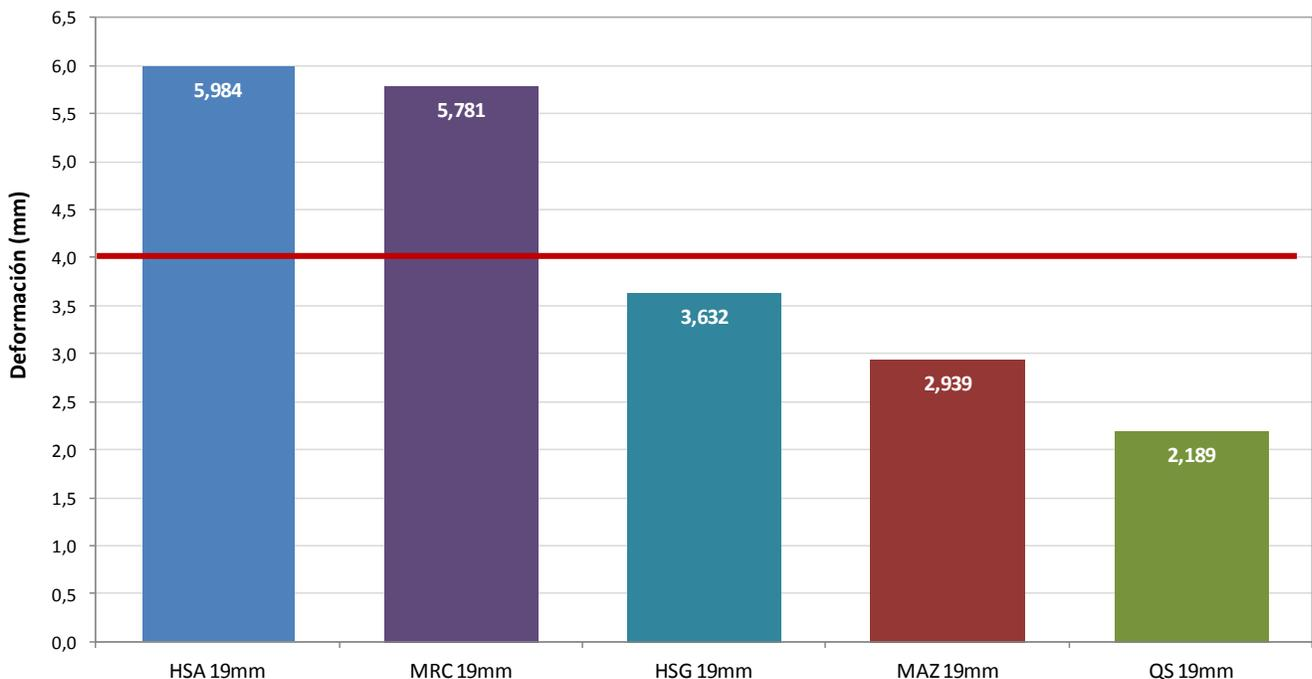
Figura 6. Resultados de Rueda de Hamburgo para mezcla de tamaño de 19 mm.
