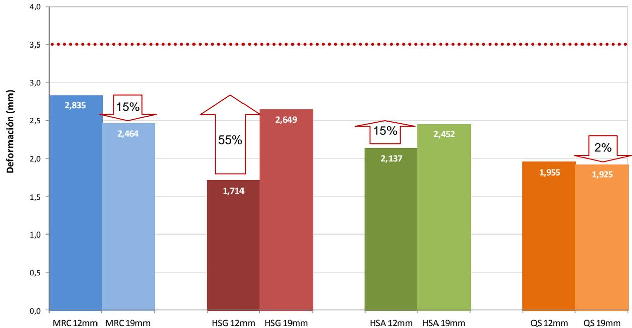
Figura 4. Resultados de deformación permanente para ambos tipos de mezcla.
